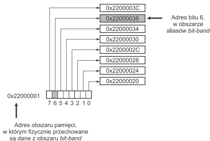
Rys. 1.4. Sposób mapowania adresów z obszaru bit-band
