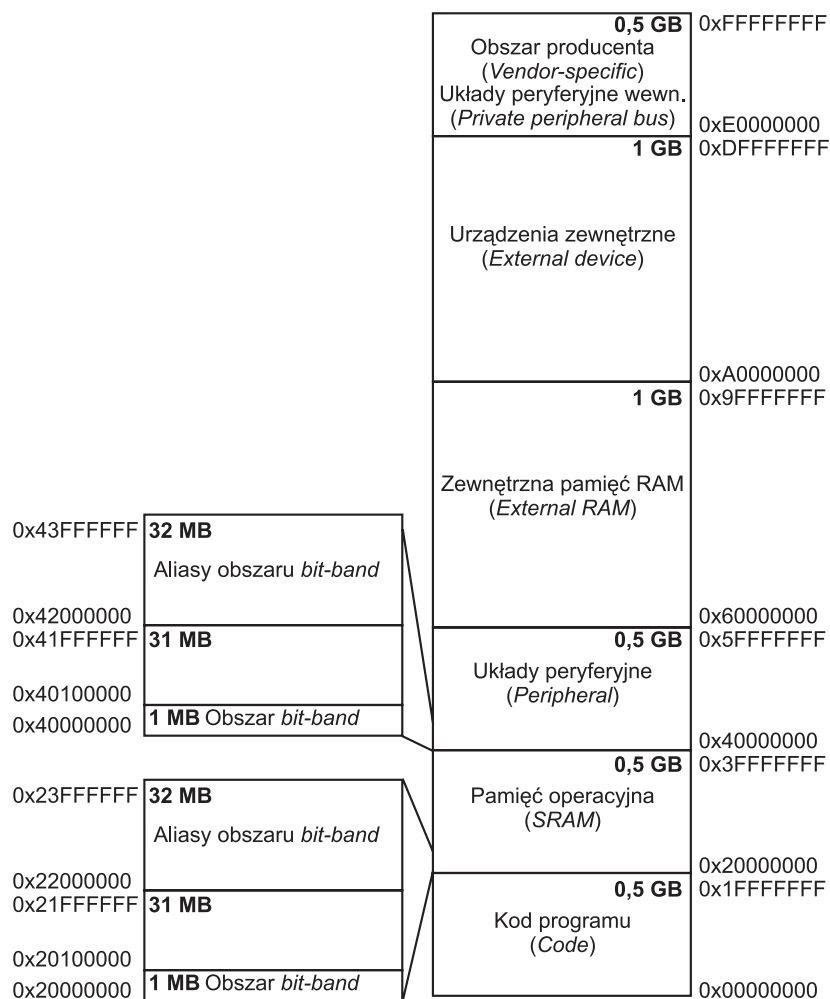
Rys. 1.3. Mapa pamięci rdzenia Cortex-M3
