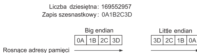
Rys. 1.5. Sposób zapisu danych w konwencjach big endian i little endian
