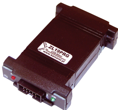
ZL19PRG USB-Byte Blaster – opcjonalny programator, kompatybilny z USB Blaster
