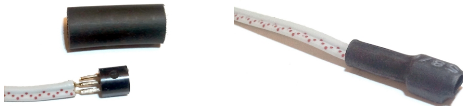
Rys. 5 Przykład zabezpieczenia czujnika za pomocą rurki termokurczliwej
